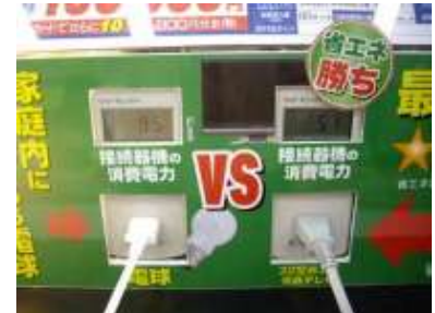
液晶テレビと白熱電球の 消費電力量の比較
